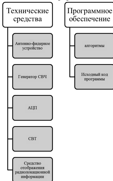
Рисунок 2 – Структурный состав комплекса технических средств обнаружения, идентификации и отображения радиолокационного портрета военной техники в общем виде
